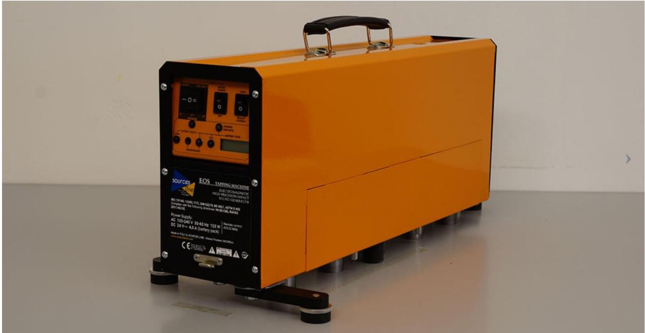
**Das Norm-Hammerwerk EOS erzeugt Geräusche zur Messung der Trittschalldämmung von Decken und Treppen. Hierzu verwendet das Norm-Hammerwerk ein einzigartiges elektromagnetisches Hebesystem. Dieses nutzt die Wirkung eines Magnetfeldes um die Hämmer perfekt mittig anzuheben und wieder fallenzulassen.**
